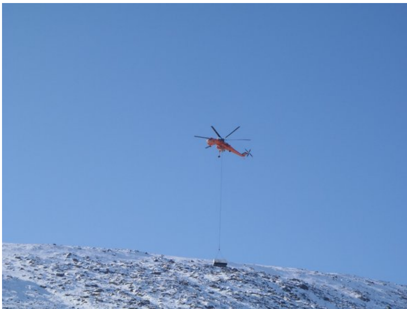
Hélicoptère-grue transportant un groupe électrogène à Pangnirtung
